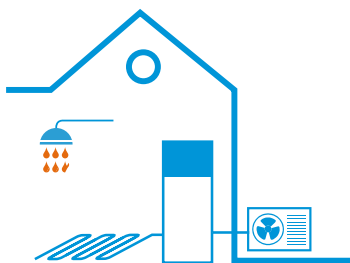
Jednotka s integrovaným zásobníkem teplé užitkové vody stojící na podlaze
