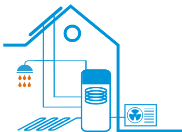
Kompaktní jednotka s integrovanou nádrží ECH 2 O stojící na podlaze
